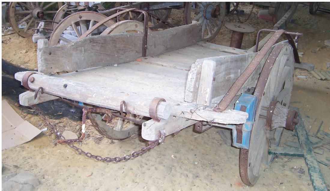
*Vista posteriore di una barosa. Sono visibili alcuni comandi: per frenare e per fissare il carico*
