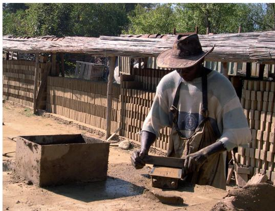
*Fig. 5 - La produzione manuale dei mattoni Sezzadio, unitamente alle forme di legno (fig. 5).*
