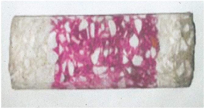
Fig. 4 - Effetto della fenolfaleina a contatto con il materiale; vira al rosso, materiale sano; incolore per valori di pH inferiori
