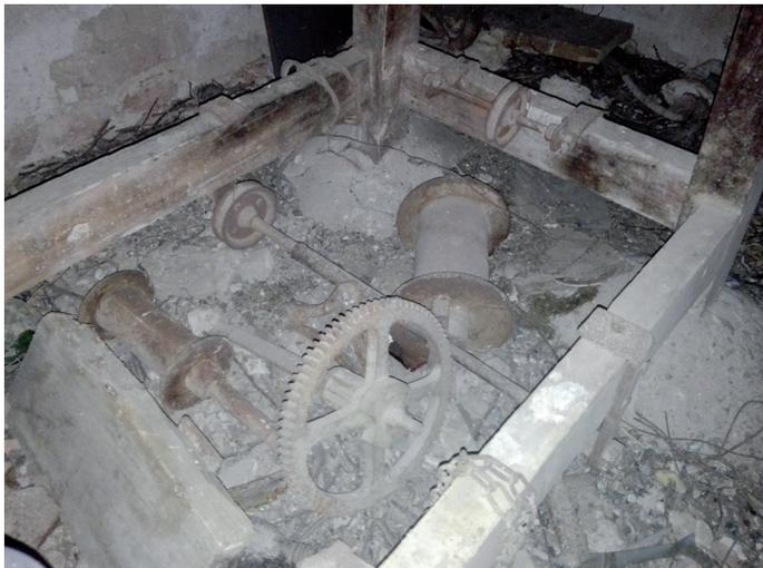
I resti del meccanismo che permetteva di mantenere una carica di due giorni per l'orologio quando non esisteva l'attuale alimentazione elettrica
